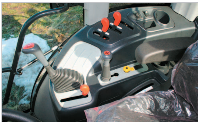
Jednoduché ovládání nářadí umožňuje v traktorech Kioti joystick Foto Vladislav Fuka
